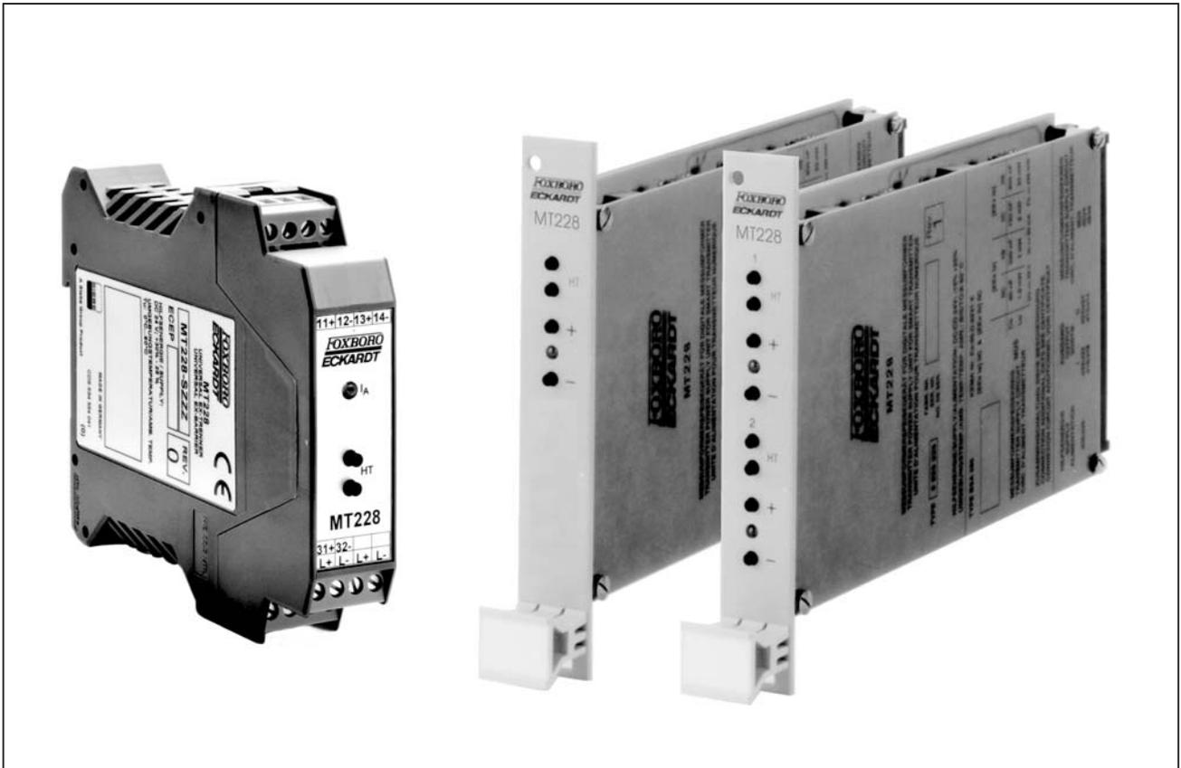
Der Universal Ex-Trenner MT228 trennt eigensichere und nicht eigensichere Signalstromkreise. Er versorgt galvanisch getrennt Messumformer und Stellungsregler mit FOXCOM-Kommunikation oder Messumformer mit HART-Kommunikation. Der Anschluss eines Handterminals oder PCs ist an jeder Stelle des Signalkreises möglich. Der Universal Ex-Trenner MT228 erlaubt die bidirektionale Kommunikation zwischen Leitsystem, Handterminal oder PC und Messumformer bzw. Stellungsregler.
